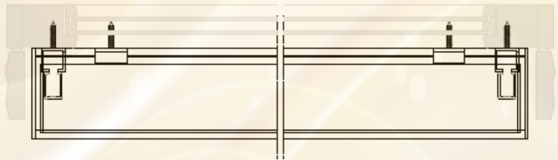
bevestiging kast door ophangprofiel fixation de caisson par profil de suspension
