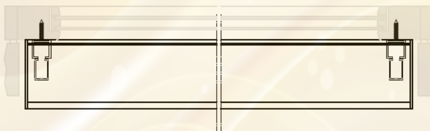
bevestiging kast door zijdelingse steunen fixation du caisson par des supports latéraux
