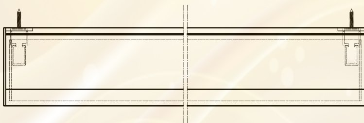
bevestiging kast door zijdelingse steunen fixation du caisson par des supports latéraux
